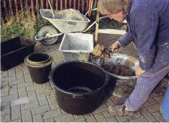
Die Kunststoffkübel dienen als Schalwände für die Beton-Mischung; zunächst wird der Boden etwa 5-10 cm dick bedeckt.
