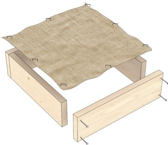
Auf die vier Bretter wird ein Tuch aus Sackleinen gespannt, das mit einer Mehlekleisterpaste eingepinselt wurde. Diese verhindert ein Zerfressen des Tuches durch die Bienen.
