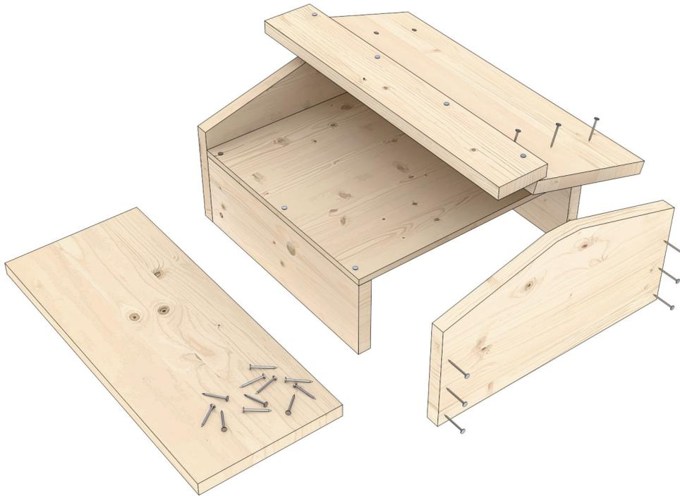
Das Dach wird nicht mit Dachpappe oder Metall versehen, wie es oft bei konventionellen Beuten zu sehen ist. Ein Metalldach verursacht bei starkem Regen ein lautes Trommeln – sehr unangenehm für die Bienen im Innern der Trommel. Dachpappe verhindert ein Atmen des Daches – unter der Dachpappe wird das Dach anfangen zu schimmeln. Am besten das Dach
